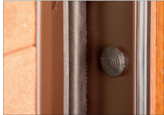
5- Puntali in gomma reggispinta. Assorbono la forza orizzontale, esercitata dal piede di porco, che va dal lato serratura verso il lato cerniera.
