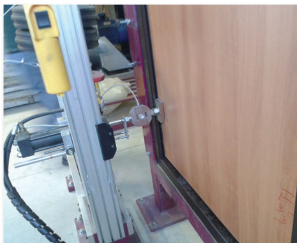
Antieffrazione: prova attacco statico.
