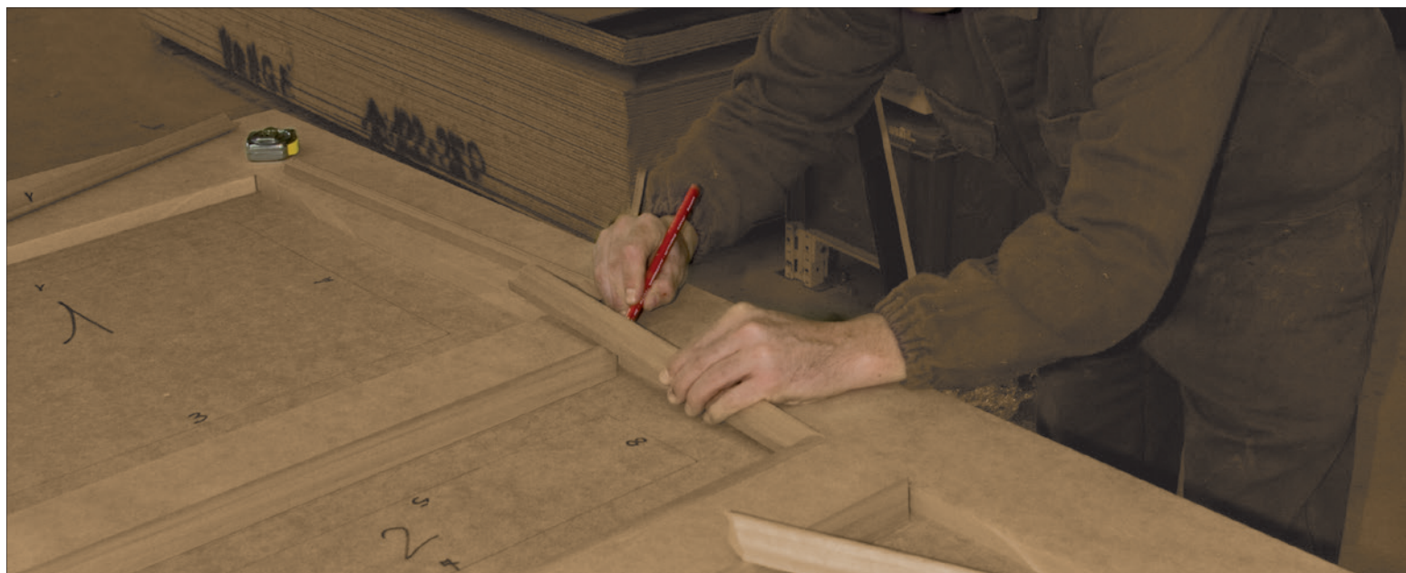
Lavorazione pannello cornici con piano a rilievo.
