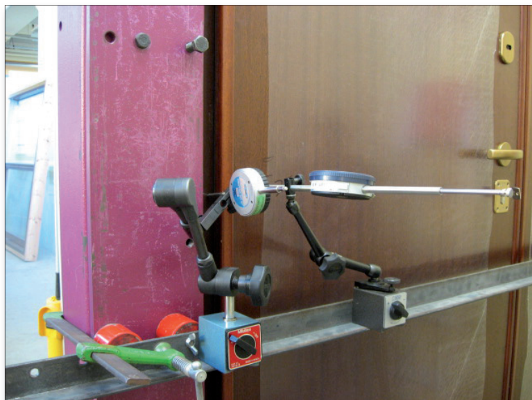
Antieffrazione: prova sotto carico statico.
