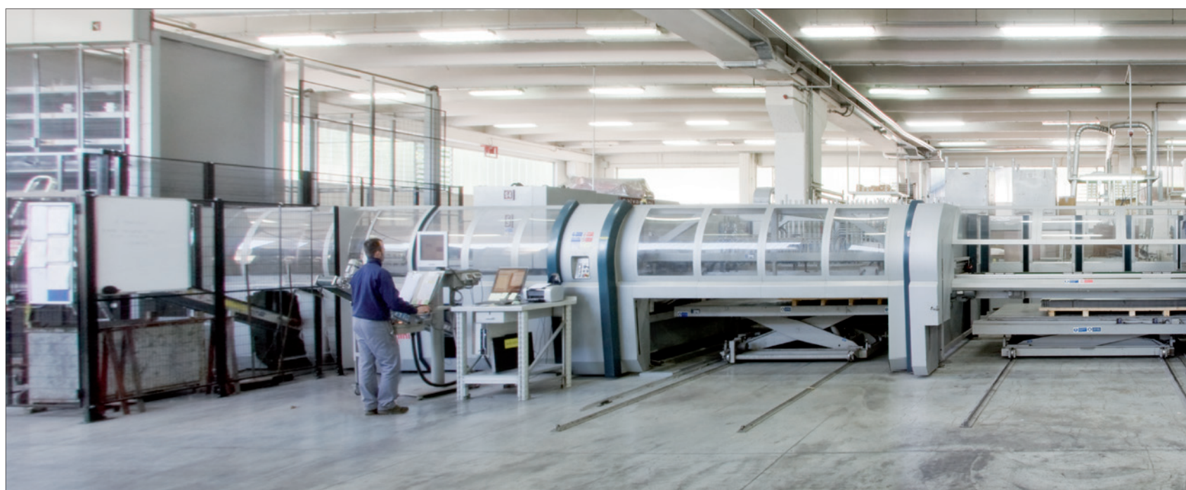
Linea automatica lavorazione lamiera Salvagnini.
