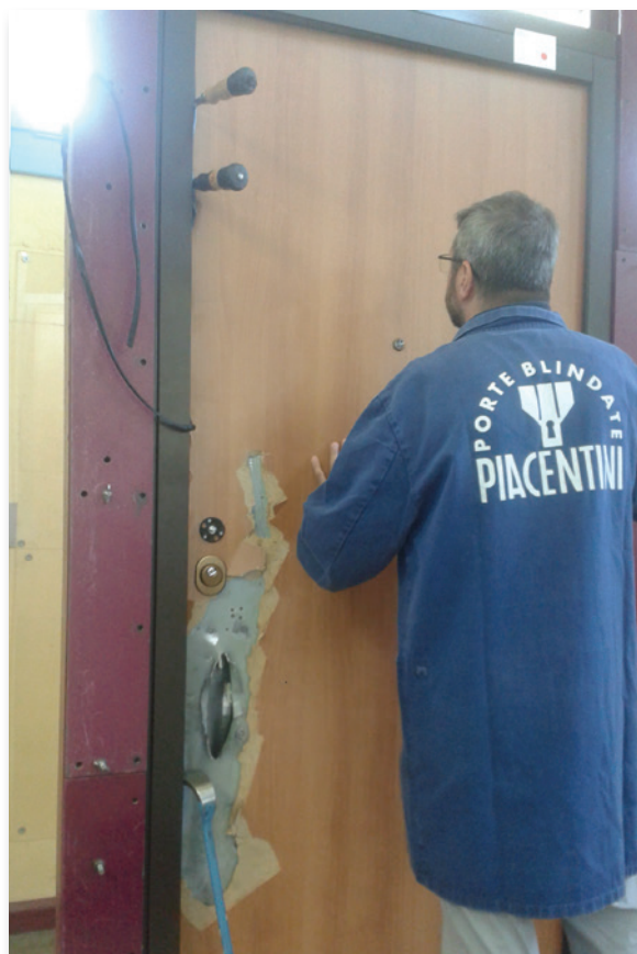
Antieffrazione: prova attacco manuale.
