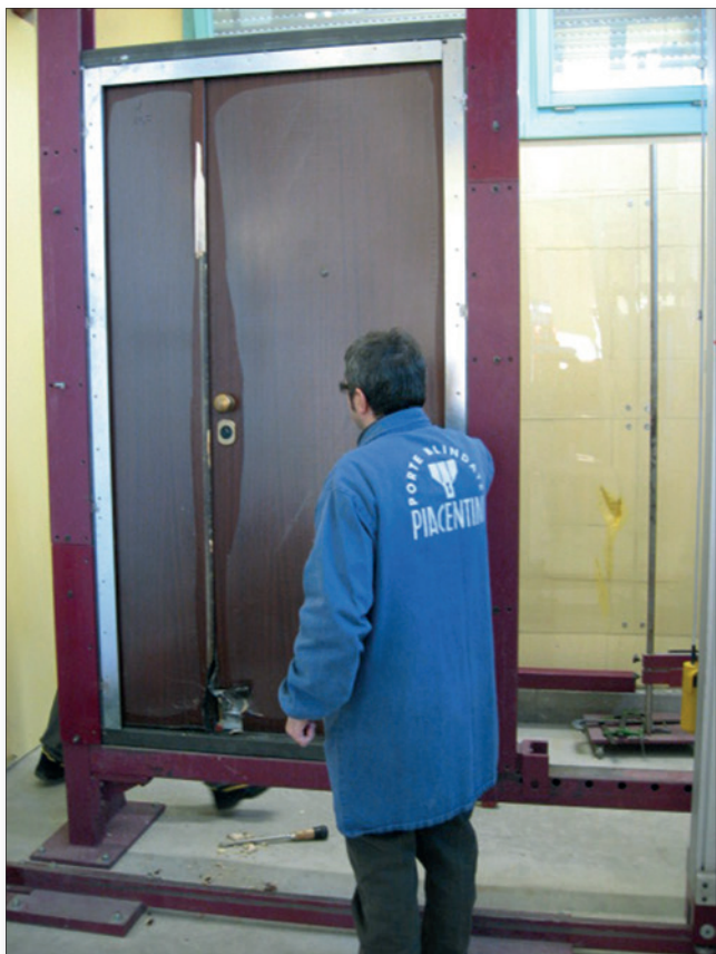
Antieffrazione: prova attacco manuale.
